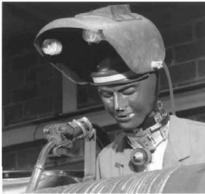
그림 1. 용접용 시료채취기 설치모습 1
